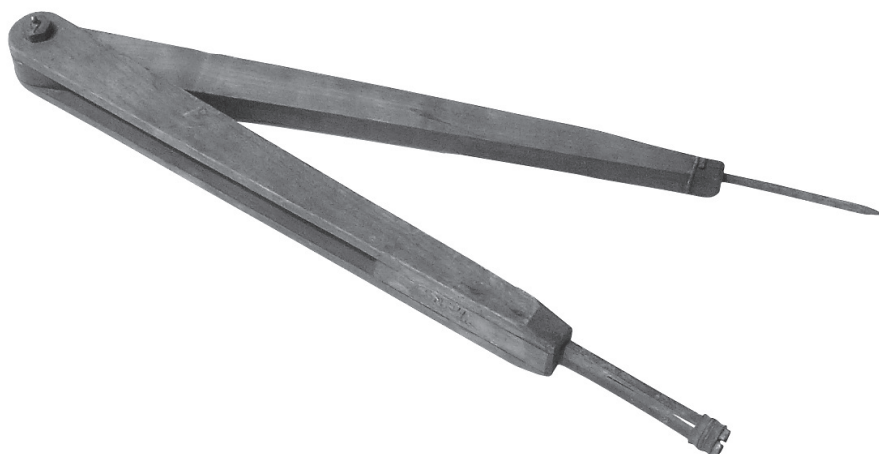
2. kép. A BM I.74.294 leltári számú körző, amelyet a párnák és terítők körformáinak az anyagon történő könnyebb kiszerkesztéséhez használtak.
